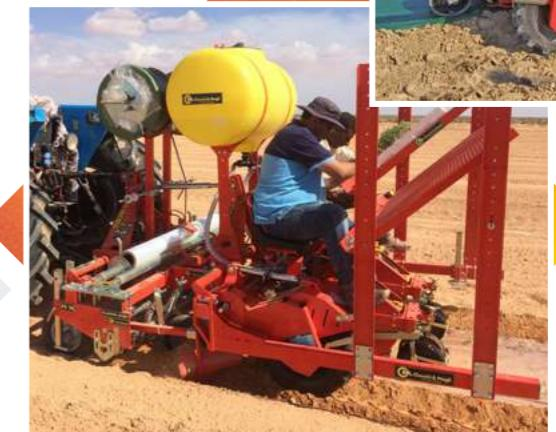
FRANÇAIS: PLASTIC STOP PLUS + WOLF permet de dérouler le film plastique (bio et non), la goutte à goutte et de planter en un seul passage. La dérouleuse PLASTIC STOP peut être combinée avec la planteuse en version soit WOLF soit WOLF COMPACT. Un kit de fixation rapide permet d'utiliser les deux machines combinées ainsi que séparément.
